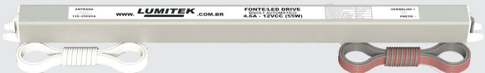
Fonte 55W - 4,6A - 12VCC Bivolt automático 110~250 VCA Dimensões: 18x18x303mm (AxLxC)
